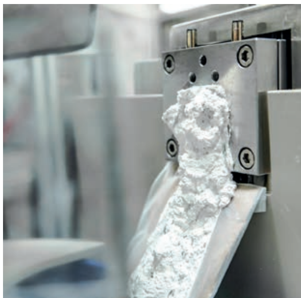
Erster Prozessschritt: Die Masse nach dem Zerlegen des PET.
