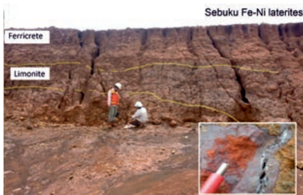
Lateritprofil von der Insel Sebuk, das den Übergang von Ferricrete zu Limonit zeigt.
