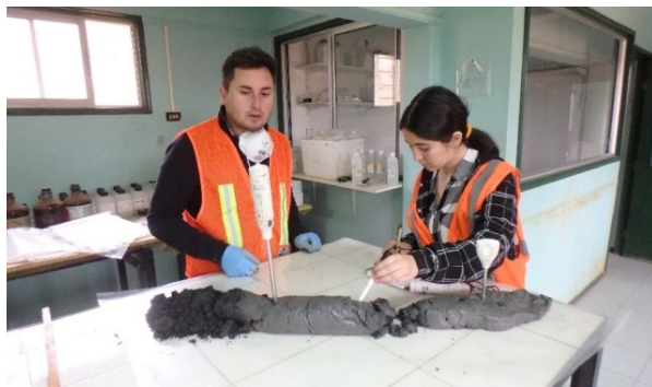
Erstuntersuchung von erbohrtem Kernmaterial eines Alttailings-Körpers im Feldlabor in Zusammenarbeit mit den chilenischen Projektpartnern.
