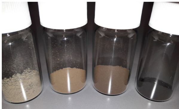
Klärschlamm nach hydrothermaler Inkohlung, getrocknet (v. l. n. r.: unbehandelt, 190°C, 220°C, 250°C).
