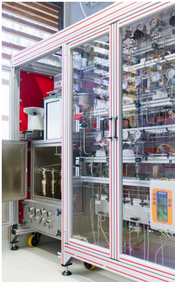
Screeningstation zum Test der Synthese von grünem Ammoniak.
