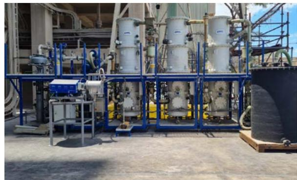
Pilotanlage zur kombinierten Abgasreinigung, Kohlenstoffabscheidung und -konversion.
