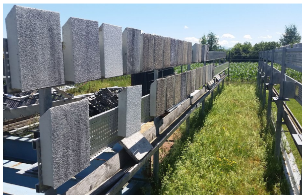
Freilandtesteinrichtung, Fraunhofer Institut für Bauphysik, Holzkirchen.
