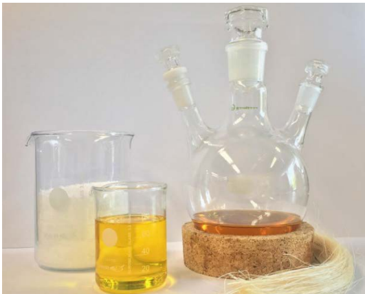
Matérias-primas utilizadas: Ácido láctico, óleos vegetais e fibras naturais, bem como um grau intermediário da síntese de polímeros no frasco de reação.
