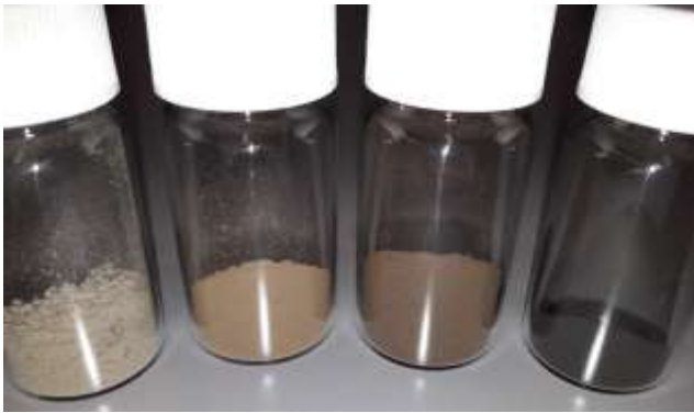
经过水热碳化处理后的脱水污泥
