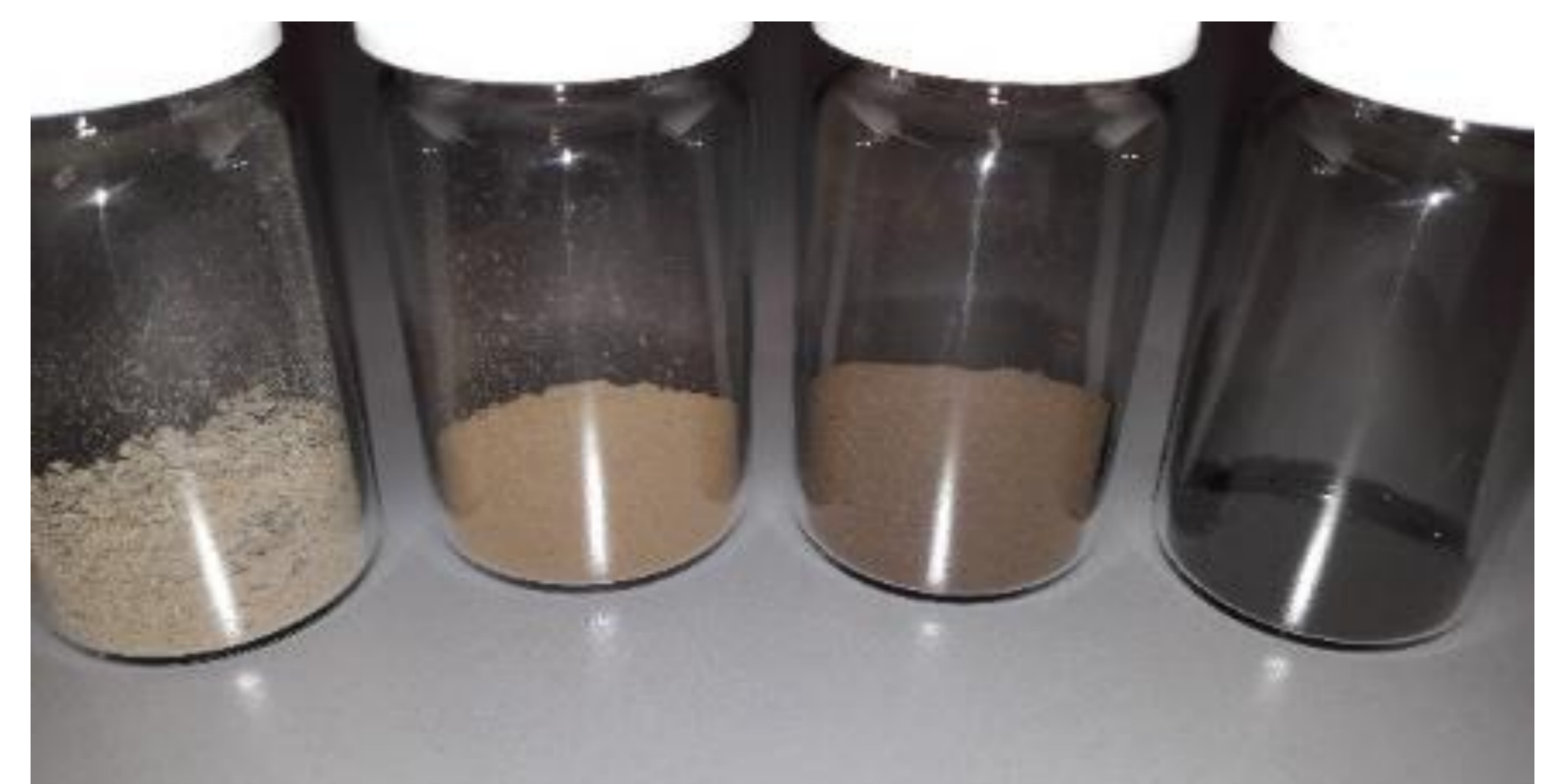
Bild 2: Klärschlamm nach hydrothormaler Inkohlung, getrocknet (v.l.n.r.: unbehandelt, 190°C, 220°C, 250°C), TU Darmstadt (2019).
