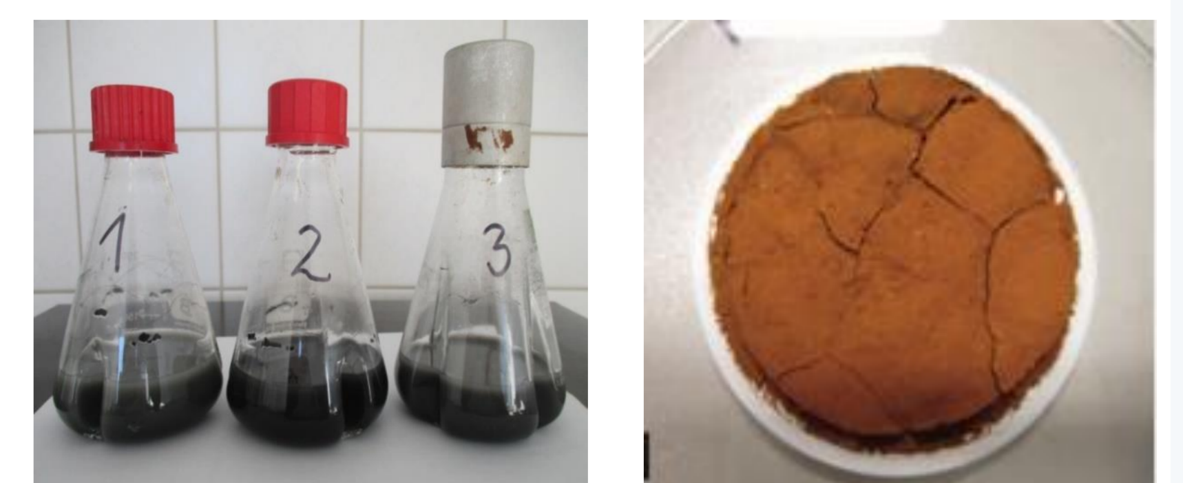
Versuche zur Laugung von Schlacken und Fällung von Schwertmannit (G.E.O.S. Freiberg)
